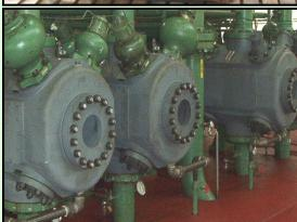
ACI'S VALVE-IN-BARREL CYLINDER
